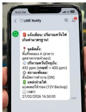
ภาพที่ 4 การแจ้งเตือนผ่านเครือข่ายเมื่อค่าความเข้มข้นของควันเกินค่าที่กำหนด
