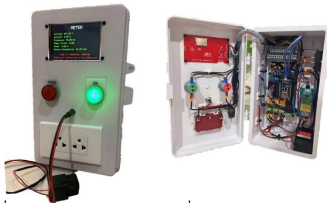
ภาพที่ 2 ลักษณะภายนอกและภายในเครื่องวัดค่าทางไฟฟ้าแบบเวลาจริง
