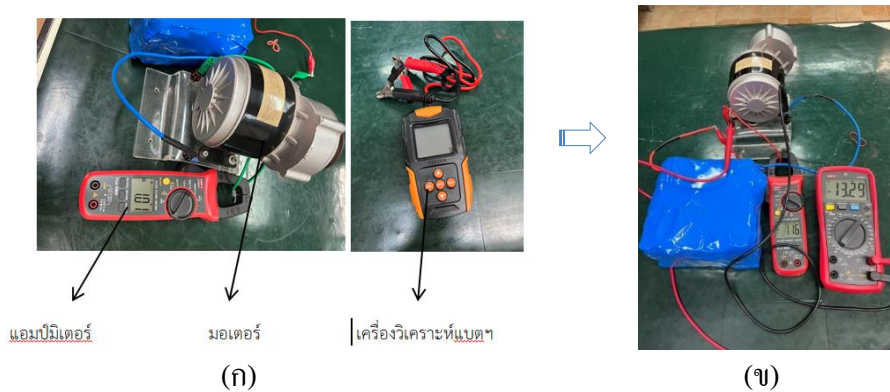
ภาพที่ 2 (ก) วัสดุในการประกอบแบตเตอรี่ลิเทียม (ข) การทดลองจ่ายประจุไฟฟ้าของแบตเตอรี่ลิเทียม
